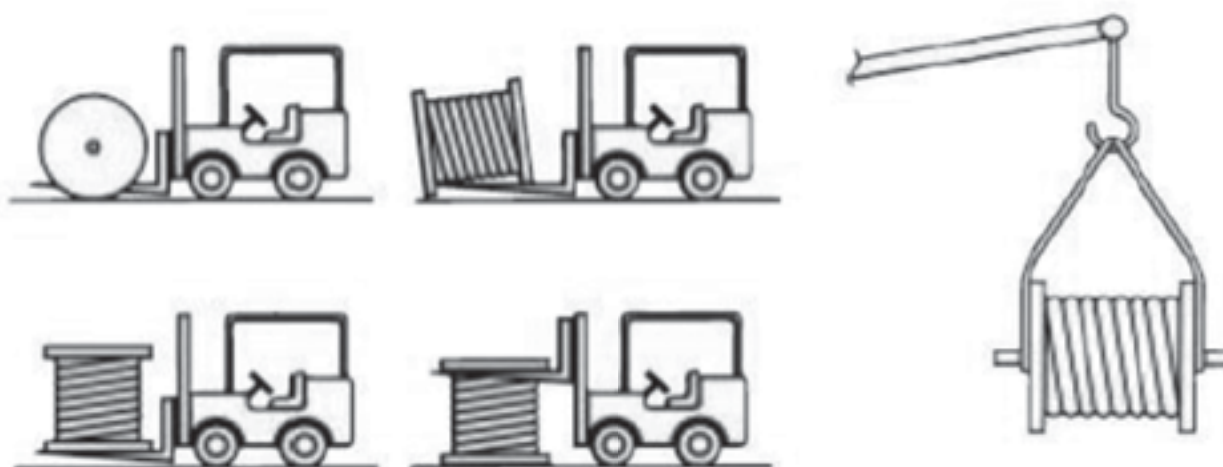
Figura 1.7c - Esempi di movimentazione delle bobine da evitare
